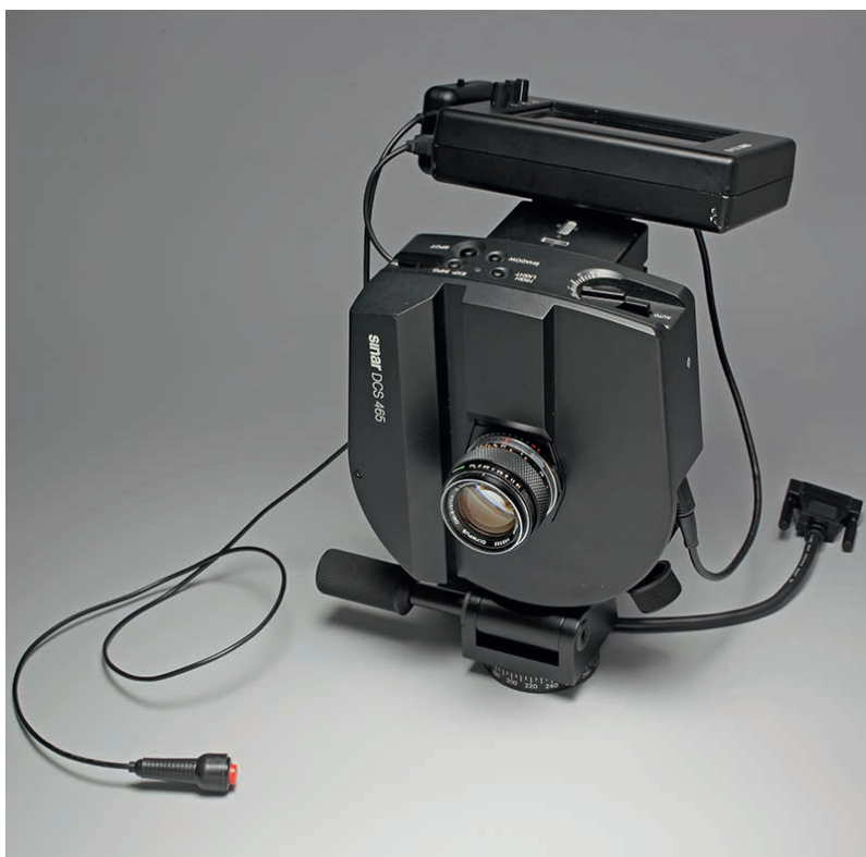
Chambre de studio numérique Sinar DCS 465, 1996, équipée d'un capteur Kodak DCS 465, d'un objectif Olympus de 50 mm et d'un écran de contrôle de grande dimension. Résolution de 6,2 MP. Collections du MSAP / no inv. 11696.
