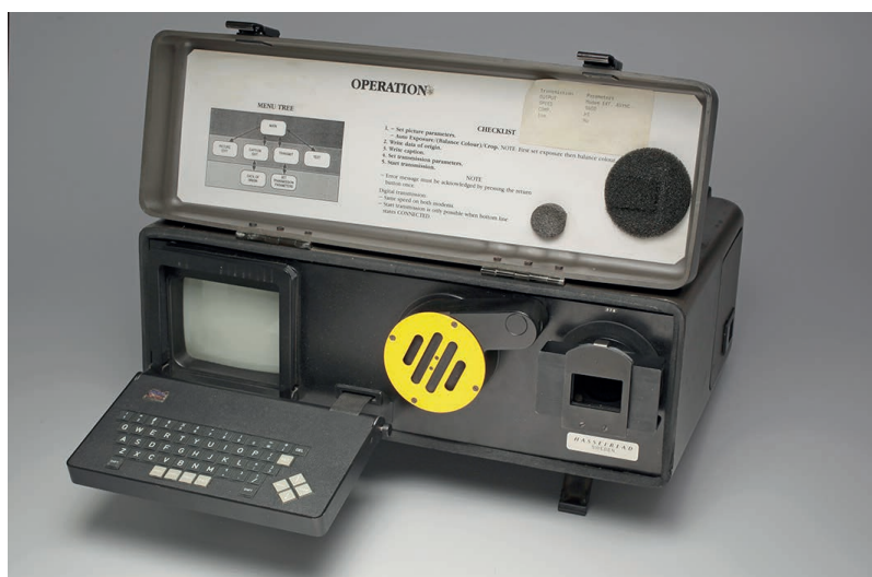
Transmetteur d'images Hasselblad Dixel 2000, Suède, 1988 Scanner et transmetteur d'images 35 mm (négatifs et diapositives). Collections du MSAP / no inv. 14962.
