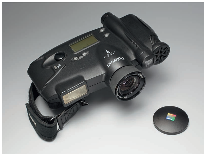
Photoscope numérique de première génération Polaroid PDC 2000, 1996, résolution de 800×600 pixels à 1600×1200 pixels. Vendu entre 3000 et 5000 dollars. Collections du MSAP / no inv. 14991.
