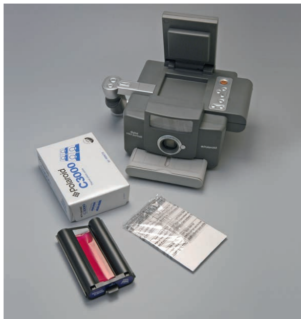
Appareil pour photos d'identité Polaroid digital mini portrait, avec imprimante à thermosublimation intégrée, USA, 2004. Collections du MSAP / no inv. 14123.
