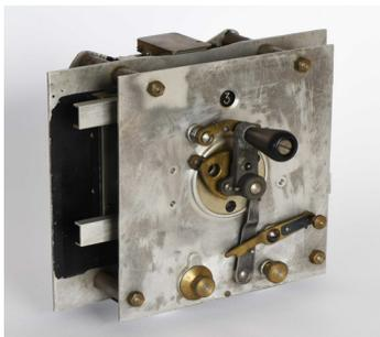
Ce prototype est équipé de la visée réflex avec volet de fermeture, du compteur de vue, de l'armement automatique de l'obturateur et du déplacement de la platine. Le tout actionné par une rotation horaire de la manivelle.
