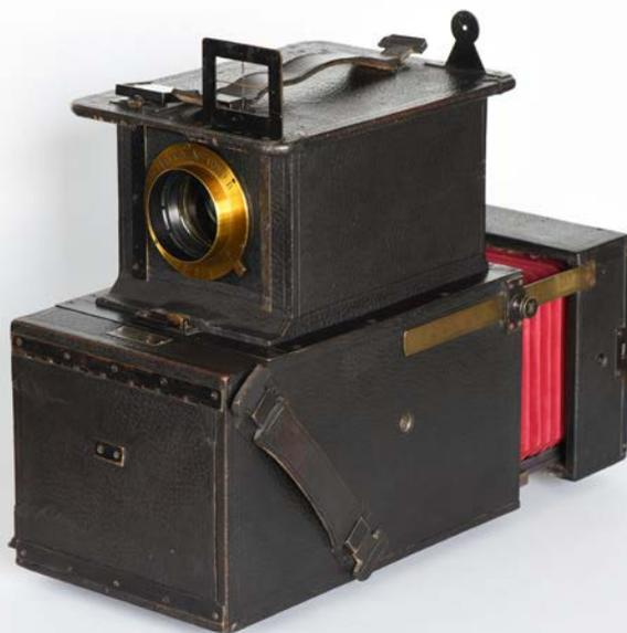
Appareil ouvert en position d'utilisation avec sa focale de 640 mm. Fermé, sa dimension sera modeste soit : Lo 320 x La 160 x H 160 mm. Avec un poids de 3 kg
