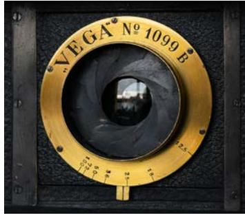
Objectif de 320 mm de focale monté sur la planchette avant. Le volet de séparation est fermé.
